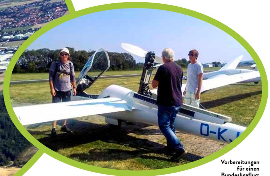
Vorbereitungen für einen Bundesligaflug: Willi Wielage (v. l.), Reinhard Schramme und Thomas Seipp checken das Klapptriebwerk des Nimbus 4M.
